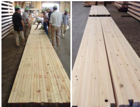
↑ 新事務所に使用される木質パネル「W-ALC ウッドエーエルシー」の加工状況 (掛川産材を製材・乾燥し、長野県で接着加工)
